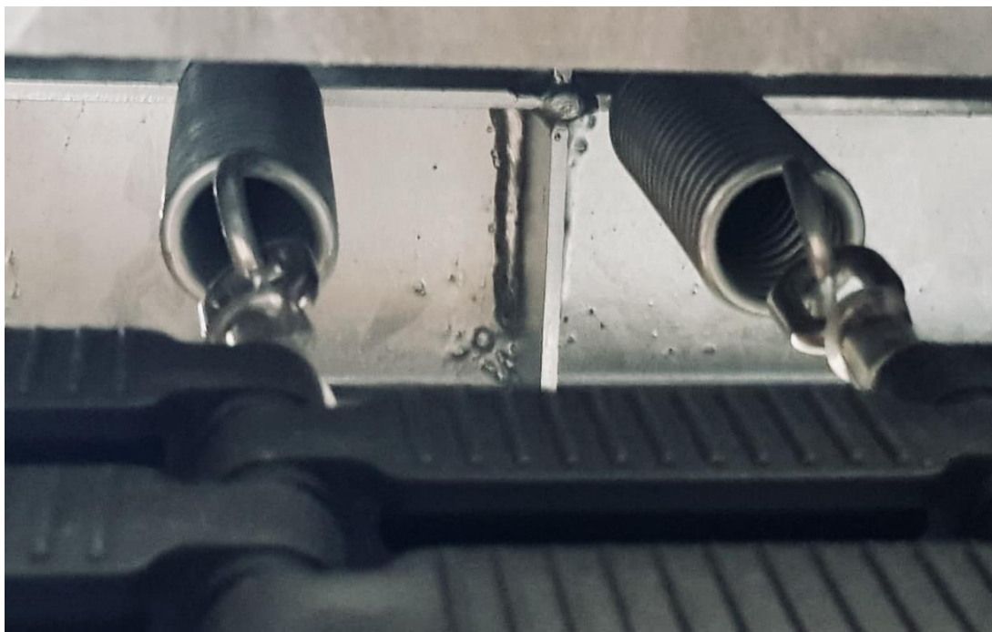
Einbausituation Federn/Matte auf der Sprungmatten-Seite mit Ösen
