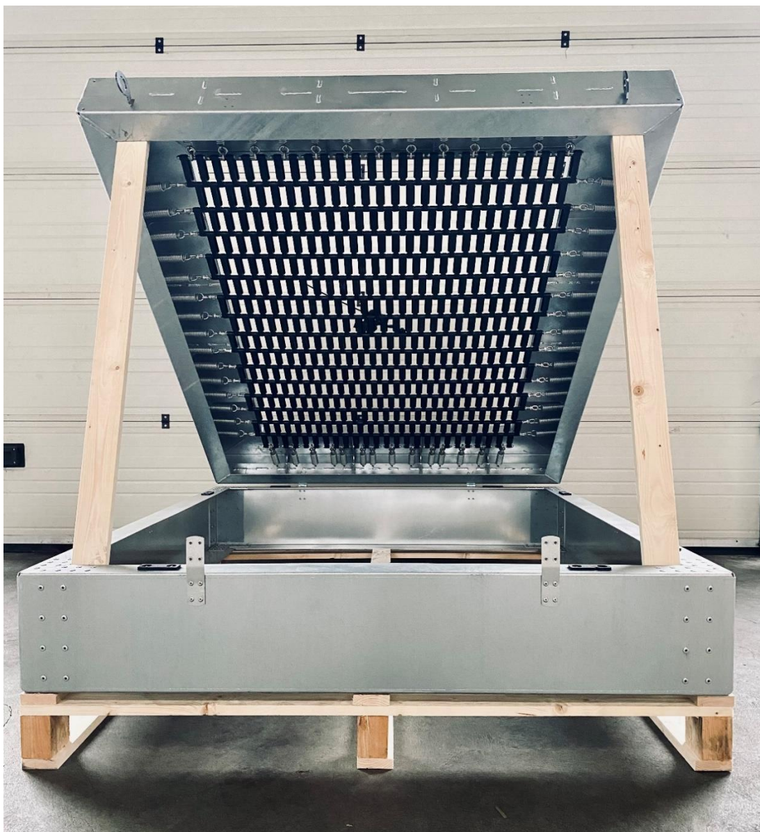
Ansicht aufgeklappter Oberrahmen für Wartungsarbeiten
