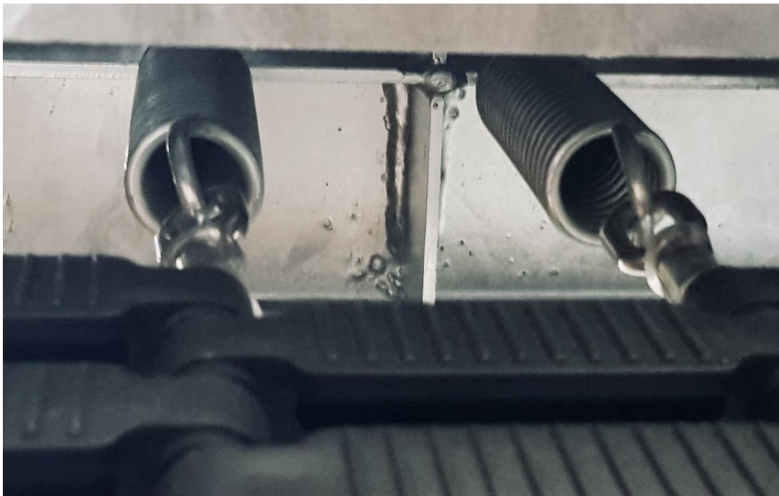
Einbausituation Federn/Matte auf der Sprungmatten-Seite mit Ösen
